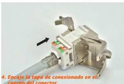
4. Encaje la tapa de conexionado en el cuerpo del conector
